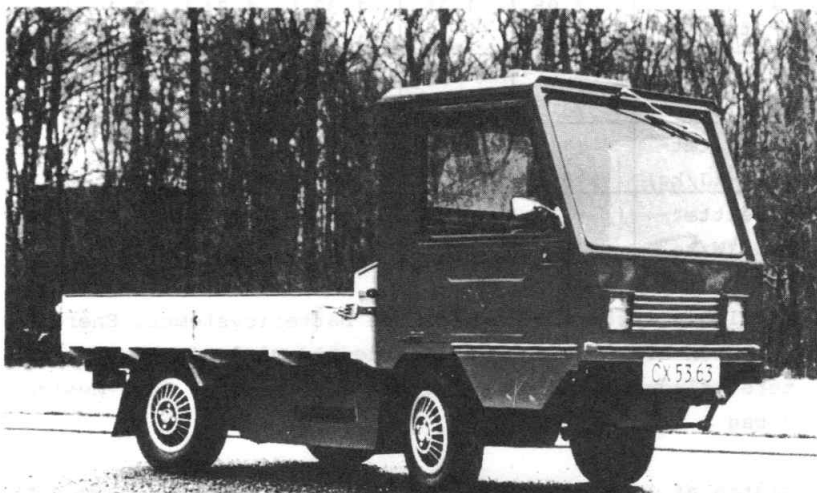
Figur 5.18 Den danske elbil M-Car, udviklet af Merrilds Maskinfabrik, Herning i samarbejde med Laboratoriet for Energiforskning, Odense Universitet.
